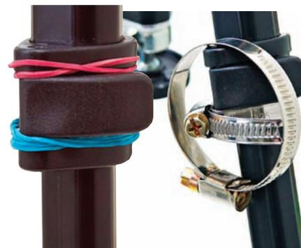
Фиксация трещины замка резинками и хомутом
